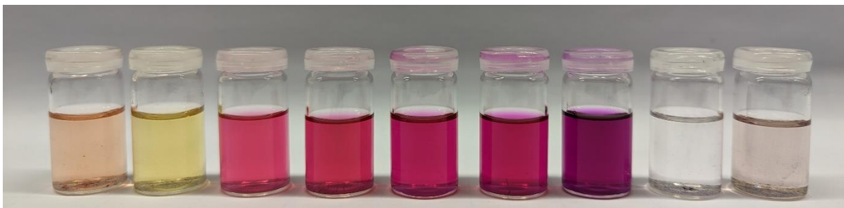
Abbildung 2: Ein Spiropyran gelöst in verschiedenen Lösungsmitteln zeigt solvatochromes Verhalten.
